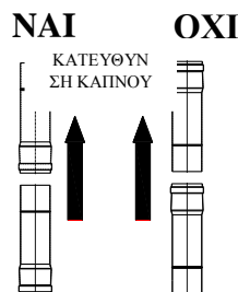
Εικόνα 7. Τρόπος συναρμολόγησης σωλήνων καπνού
