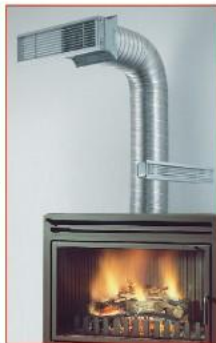
• σωλήνας αλουμινίου διοχέτευσης Ζεστού αέρα Ø 14 cm • σωλήνας παροχής εξωτερικού αέρα Ø 10/16 cm
