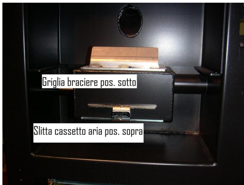
Εικόνα 28 Φωτογραφία σχάρας και θαλάμου καύσης
